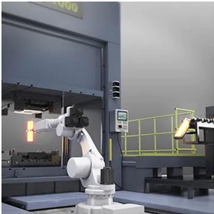
ピストンなどのエンジン部品、ギアなどのミッション部品、そのほかブレーキやドライブハブのような強度を必要とする自動車部品製造には欠かせない熱間鍛造加工。しかし、熱間鍛造加工は高温・振動・騒音・粉じんなど過酷な環境下で行わなければなりません。このような人体への負担が大きい場所での作業でロボット化のニーズが高まっています。こちらの事例では、加熱炉・溶解炉・熱処理炉に素材を投入したり、製品を取り出したりするためのハンドリングシステムとしてロボットアームを導入しています。
