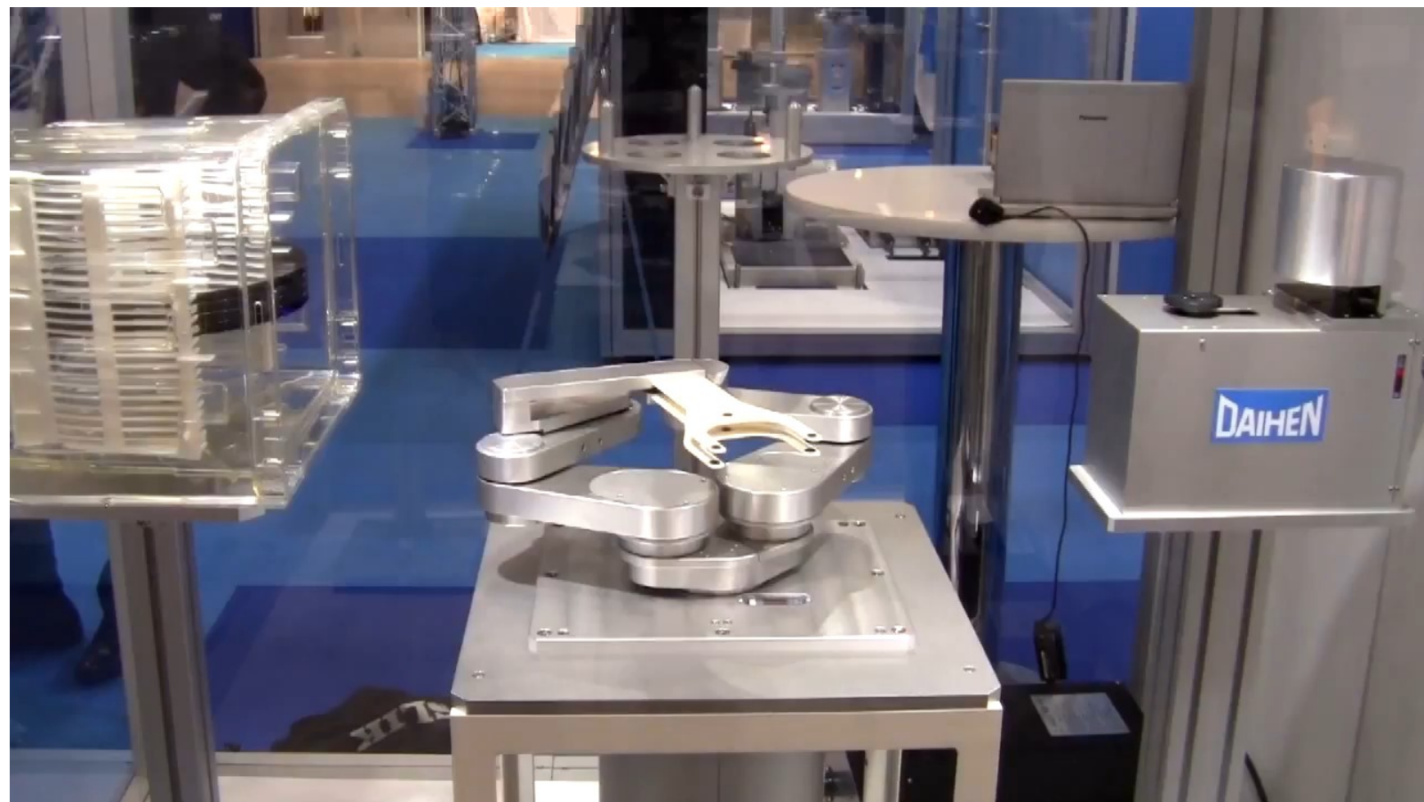
円筒座標 回転軸を中心にアームが上下方向に移動し、さらに伸縮する。
